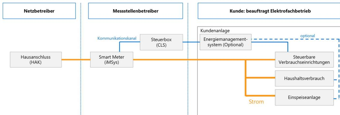
Abbildung 1: Zuständigkeiten und Verantwortlichkeiten bei der technischen Anbindung steuerbarer Verbrauchseinrichtungen
