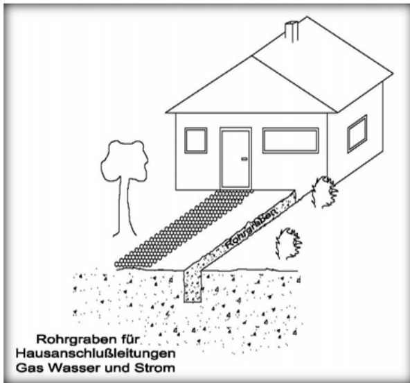
Bild 1: Musterrohrgraben für Hausanschlussleitungen Gas; Wasser, Strom und TK
